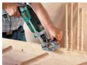
pochylna, dwukolumnowa prowadnica z podziałką, do wiercenia w poziomie, pionie i pod kątem (+/- 45°)
