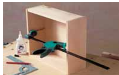
prosta przebudowa do funkcji rozpieraka
