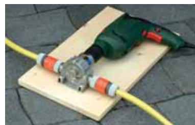
nasza rada: pompa + wiertarka + deska
