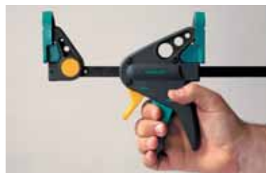
dla profesjonalistów: prosta przebudowa ścisku w rozpierek, demontaż szczęki jednym naciśnięciem przycisku
