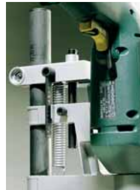
ogranicznik głębokości wiercenia
