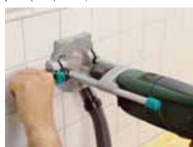
dodatkowy uchwyt dla dokładnego ustawienia i zabezpieczenia przed przemieszczeniem wiertarki podczas wiercenia
