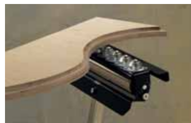
podparcie kulkami łożyskowymi pozwala na przemieszczanie obrabianego materiału we wszystkich kierunkach, np. podczas frezowania
